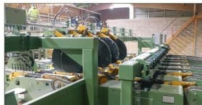
Kappstation und Messbalken für die Brettvermessung im Querdurchlauf (Materialzufuhr im Bild von links)
