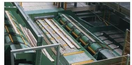
Zweistufige Brettvereinzelnung mit zwischenliegendem Schraubrollenförderer zur Ausrichtung an der Null-Linie
