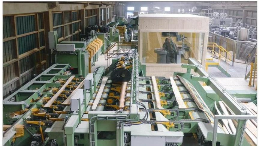
Übersicht über die im Dezember installierte „Optidrive“-Besäumanlage: Von rechts erfolgt die Zufuhr der Seitenware aus dem Vorschritt der Spanerlinie über die Entzerrer auf den Querförderer vor dem gekapselten Bedienstand. Nach der stirnseitigen Kappung und der Vermessung im Querdurchlauf erfolgt die Ausrichtung des Brettes vor der zweiten Vermessung im Längsdurchlauf. Dahinter die geschlossene Zuführung (gelbe Haube) zur Besäumkreissäge, hinten links im Bild.
