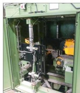
Integriertes Microtec-Messsystem für die Vermessung im Längsdurchlauf
